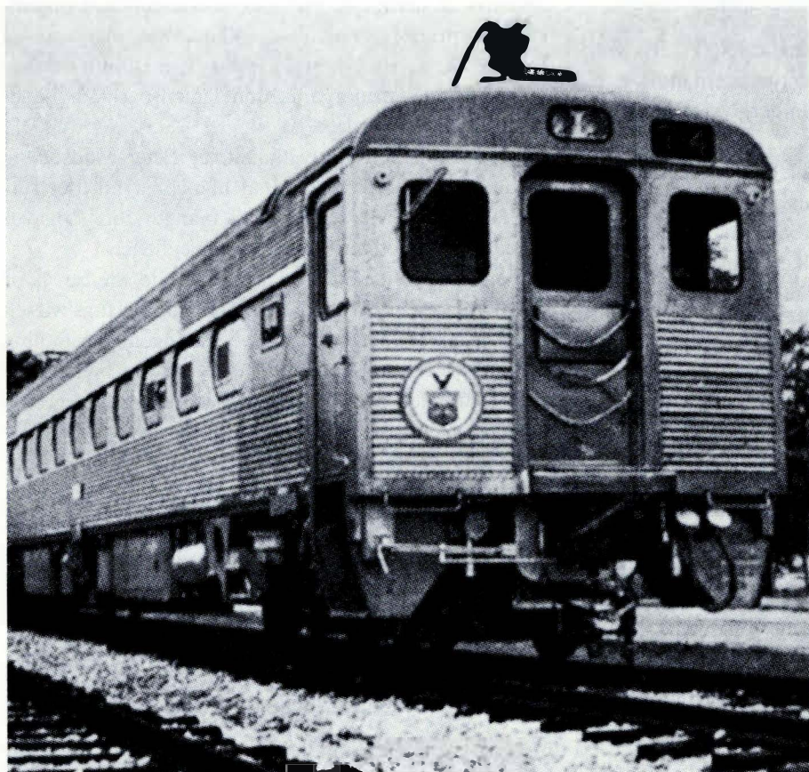
Et af de selvdrevne en-vogns-tog fra de amerikanske Budd-fabrikker. Kæmpemæssige batterianlæg af særlig konstruktion fungerer som drivkraft.
